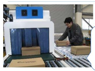
X線検査装置の中に 高性能カメラをセット。そして撮影用ワークが自動で流れる ようにコンベアを導入して調整しました
