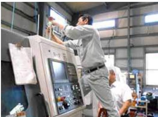
▲ 設備に光センサーもしくはリードスイッチを設置
