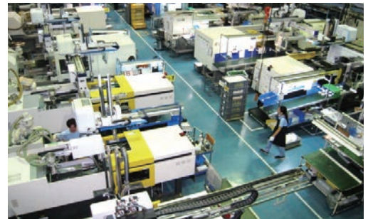
▲ 主力製造設備である射出成形機が並ぶ工場
