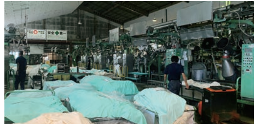
▲ 小量多品種の受注に対し、工場投入後は、台車に材料と加工伝票を積載し、工程間を移動。
