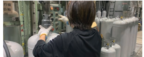
▲事業開始から約30年、全ての人に安心してLPガスを使用してもらうために行っている容器の再検査事業
