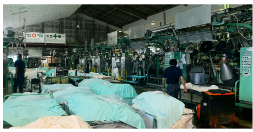
▲ 小量多品種の受注に対し、工場投入後は、台車に材料と加工伝票を積載し、工程間を移動。
