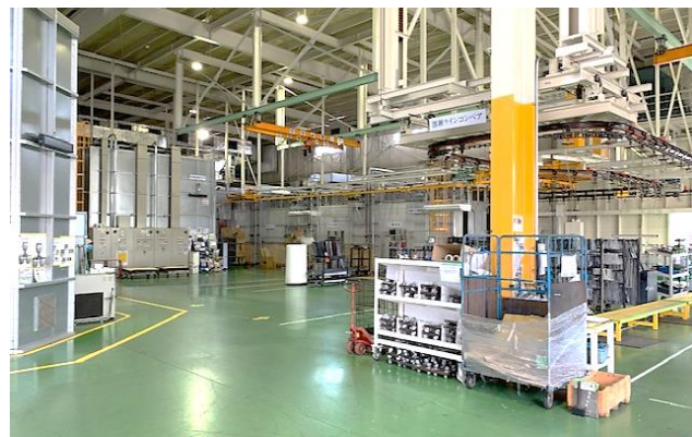
溶剤、粉体、2つの大型自動塗装ラインを有する工場
