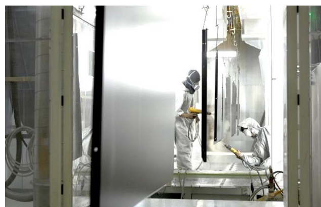
粉体ラインにおける塗装ブース
