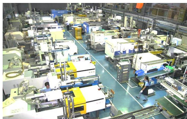
主力製造設備である射出成形機が並ぶ工場
