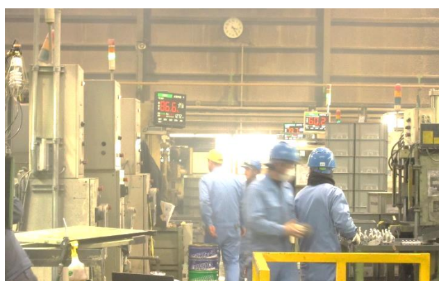
現場でモニター表示している様子（管理者は遠隔から確認）
